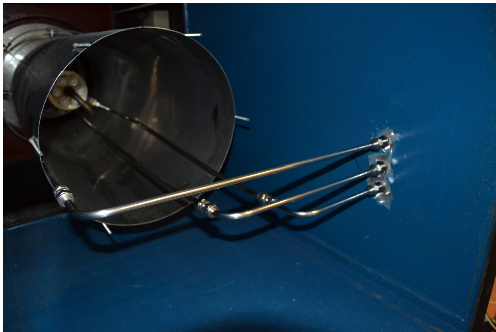
FIGURA 3.1: Differenti condotti di immissione del combustibile, dall'alto verso il basso: VeLoNOx™, Pilota (non utilizzato) e Lancia.
