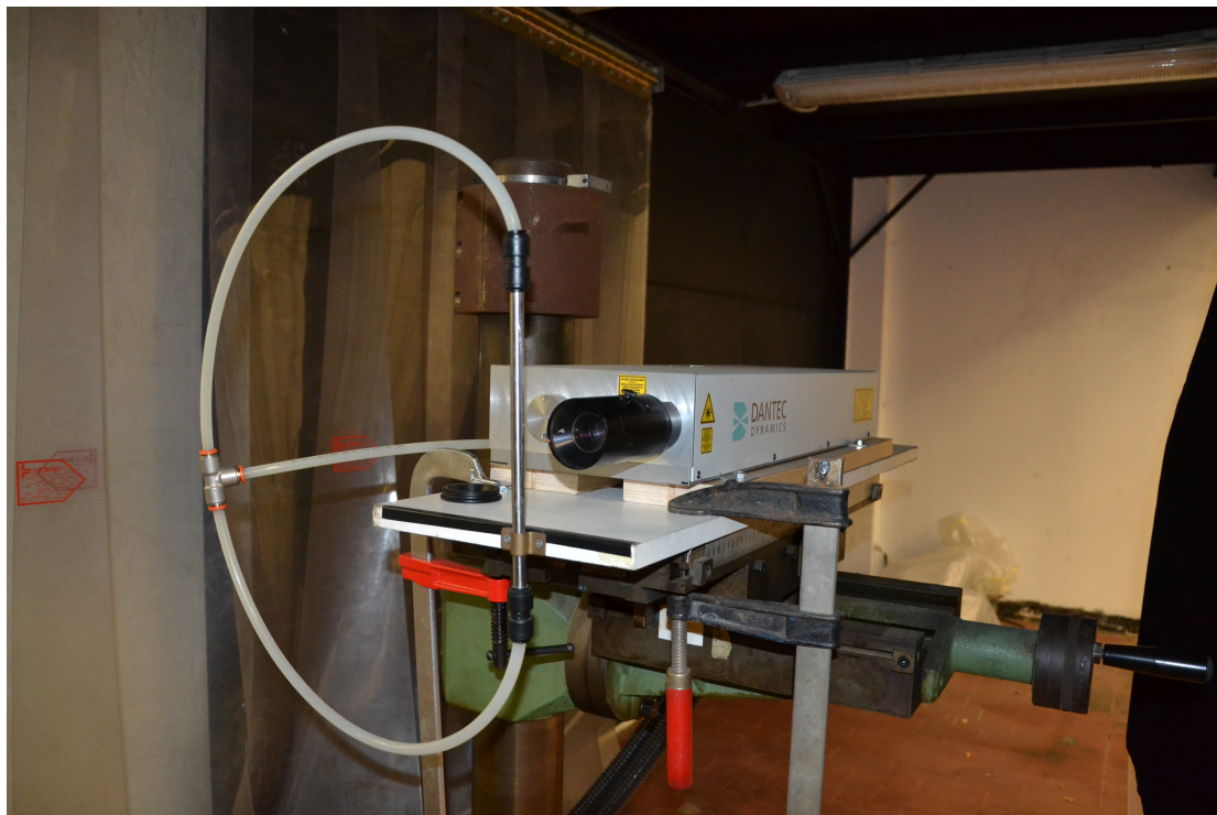
FIGURA 2.3: Laser DanTec Dynamics montato su un supporto in grado di regolarne la posizione con precisione.
